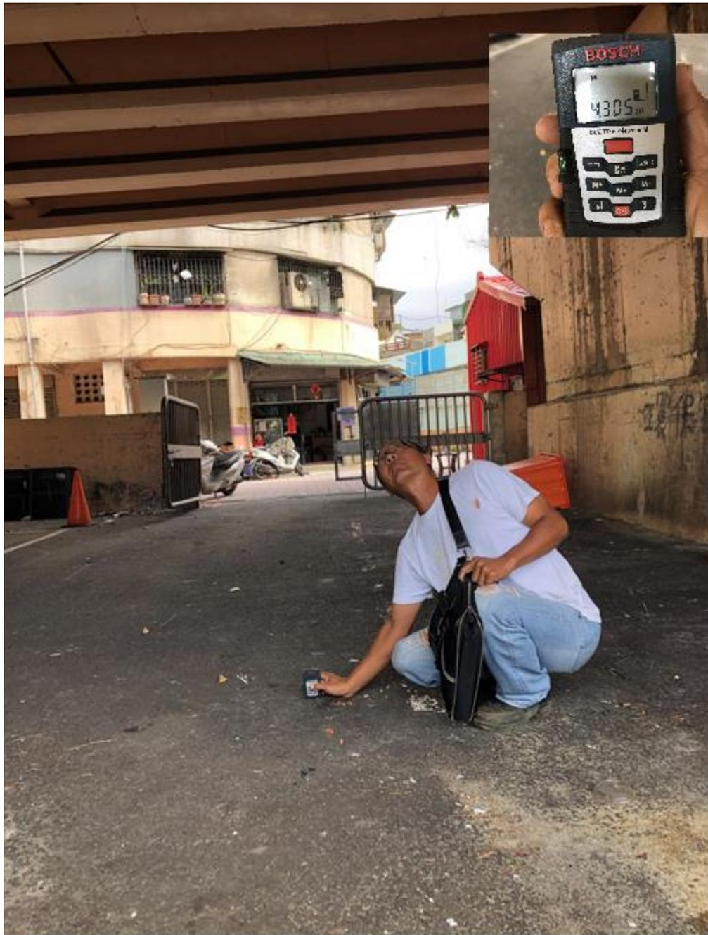
圖 8：涵洞高度測量
